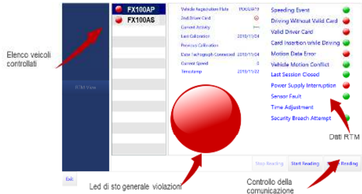
Fig. 3 Configurazione del software di lettura dei 19 dati RTM (immagini copyright VDO)
