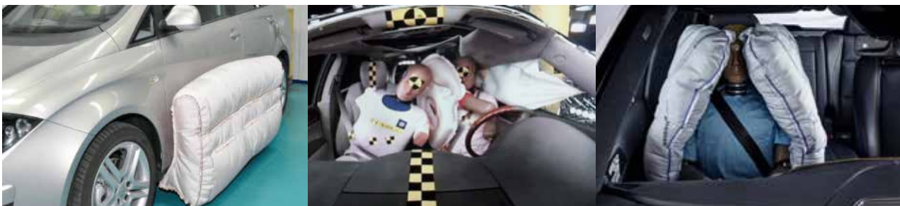
Airbag esterni a protezione degli urti
