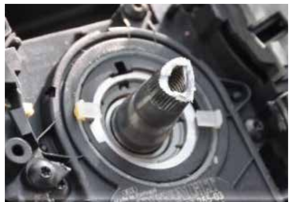
Piantone dello sterzo cavo, sezionabile dietro al volante
