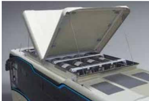
autobus GNC questi mezzi possono contenere anche 8 bombole di CNG
