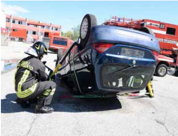
Nell'immagine: un veicolo capovolto sul tetto e stabilizzato
